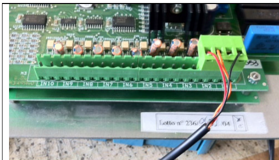
esempio di connessione pressostati presenti su manometro e relativa connessione a scheda DZ MedicaLe ALLMxxA
